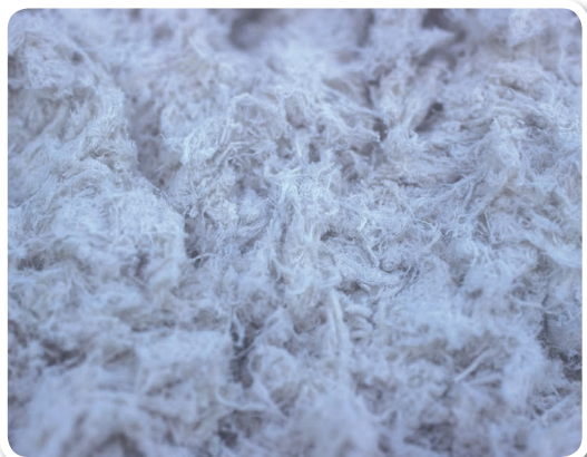
Fibre di asbesto
